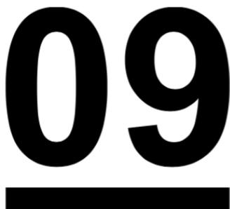
Сочетание из двух цифр, выкладываемых вертикально на КДП или около него, указывает воздушному судну, находящемуся на площади маневрирования, направление взлета, выражаемое в десятках градусов, округленных до ближайших 10 град. магнитного компаса.
