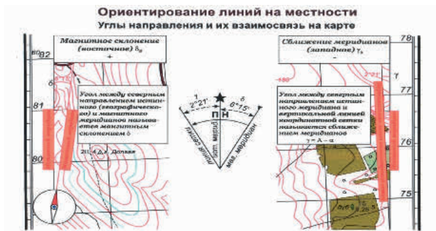
Рисунок 29. Ориентирование линий на местности. Углы, направления и их взаимосвязь на карте.
